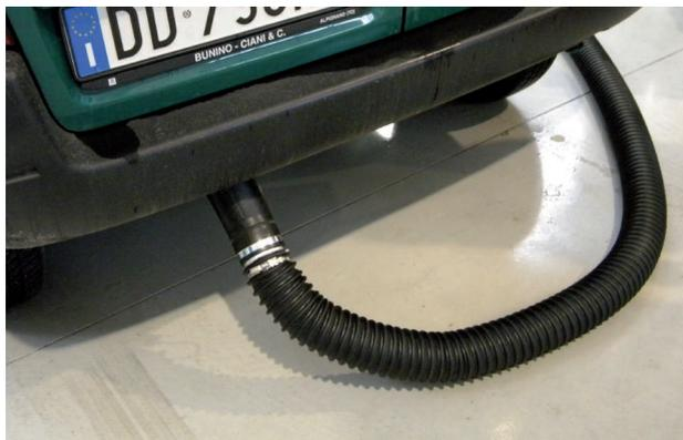
**Collaudo vettura:** tramite apposite cappe di aspirazione complete di prese di prelievo fumi per non inquinare l'ambiente di lavoro.
